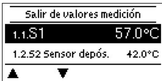
Sirve para visualizar las temperaturas actuales obtenidas en la medición.
