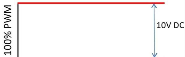
Datos técnicos 0-10V: 0-10V: 2V a 10V (20% a 100%) Diseñado para una carga de 10K Ohm. 10 V = 100% Velocidad 5 V = 50% Velocidad 2 V = 20% Velocidad 0V = Apagado
