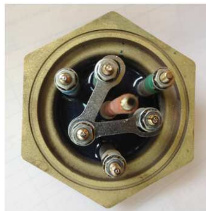
Vista de conexiones de la resistencia
